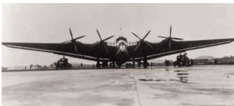
Datidens verdens største fly under åpningsstevnet på Sola. Flyet er en Junkers Ju-28 med navn «Feldmarschall von Hindenburg». Spesielt for flyet var de store vinduene i vingeroten hvor passasjerene kunne se framover.
