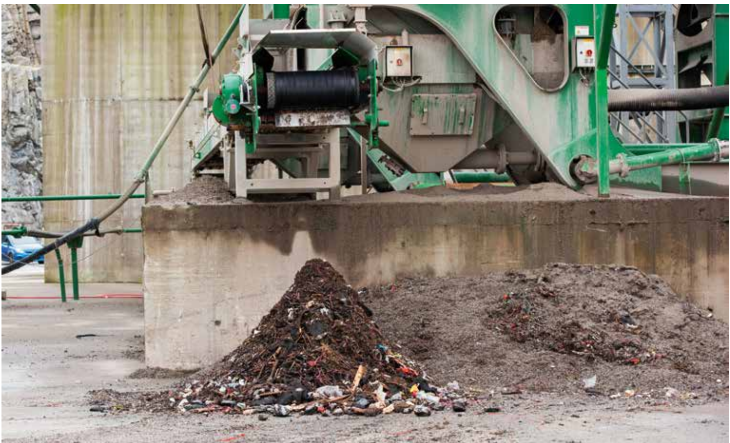
Anlegget som vasker og sorterer deponimassene skiller også ut avfall som blir liggende igjen i små hauger før de håndteres som vanlig avfall.
